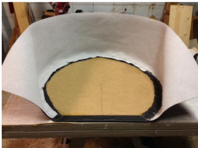
*Confection avec de l'isorel et du simili cuir d'un cache-roue sur mesure (face collée et côté agrafé au moyen d'une cloueuse-agrafeuse avec agrafes de 5 mm.*
