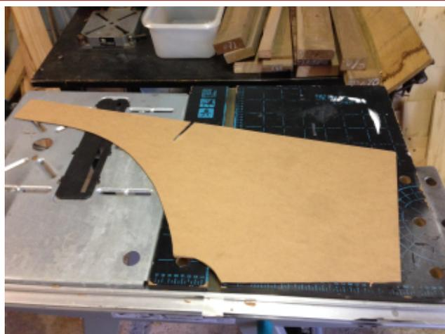
*confection de patrons approximatifs pour les côtés du coffre en papier journal, puis en carton plus ajustés, puis en isorel avec un ajustement final au cutter pour positionner la pièce au mieux dans son logement.*
