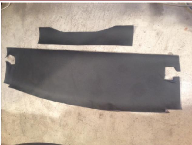
*Confection de pièces de simili cuirs à coller sur les parties arrière du coffre (entre les blocs optiques et en dessous) avec de la colle en bombe pour plus de facilité. La confection de ces pièces s'est faite également à partir de patrons en journal.*
